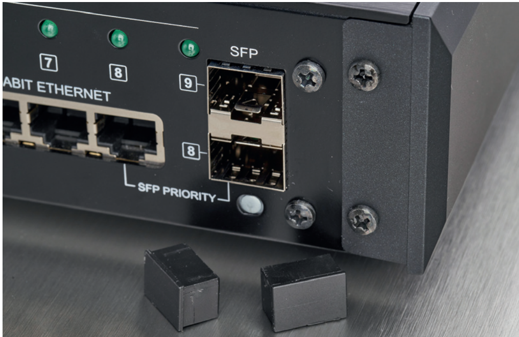
Die beiden optischen SFP-Anschlüsse finden momentan nur bei Lumin-Komponenten entsprechende Gegenstücke, können aber auch bei Verwendung von Medienkonvertern genutzt werden
